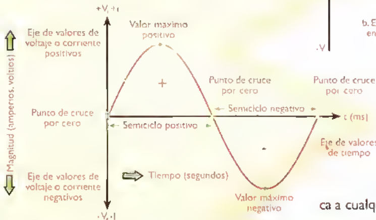
Figura 6.6 Ciclo de una forma de onda senoidal. Las corrientes y voltajes senoidales son las formas de onda que más se presentan y más se utilizan en los circuitos eléctricos y electrónicos.
